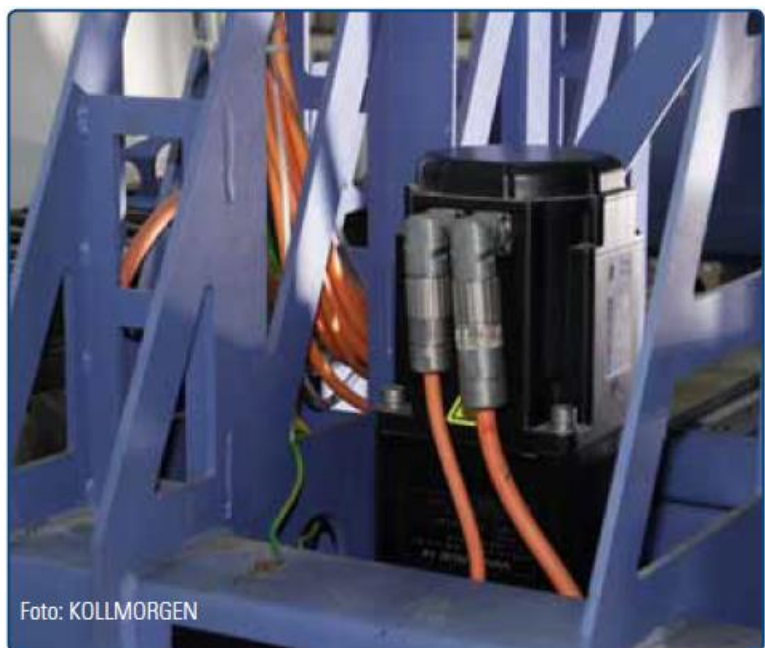
Die neue Generation der Flachbettschneidmaschinen setzt auch Kollmorgens rotatorische Servomotoren der AKM-Serie mit Mircon-Planetengetrieben ein.
